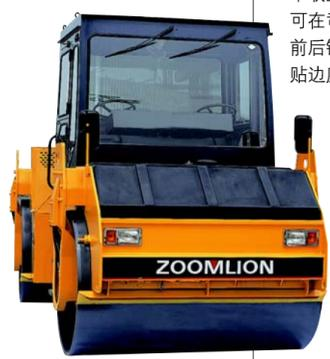
中联重科专有的自动控制蟹行机构，可在司机室内方便地自动控制。前后钢轮可相对横向错开 170mm，贴边压实和弯道压实性能特别好。
