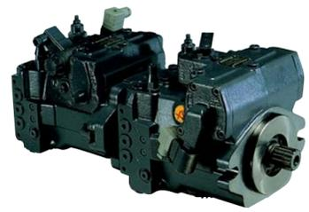
所有阀块都集成在泵和马达上，系统中看不到分立的阀块，高度集成化的液压系统设计，使得管路的布置非常简洁，保证液压系统的高可靠性，系统的维护只需定期更换滤清器，无需其他考虑。
